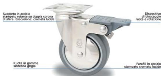
Disponibile dal diametro 40 al 125 mm. L'impiego è consigliato sia nel campo dell'arredamento sia in quello professionale e industriale. Piastra, perno filettato e foro. Tutte le tre versioni disponibili con e senza dispositivo di bloccaggio (rotazione del supporto e della ruota). In foto, art. 220CBIS, piastra girevole con freno diametro 80 mm.
