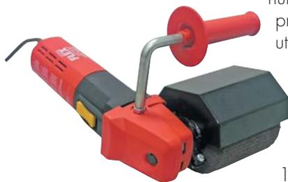
numero dei giri e avviamento progressivo. Attacco utensile Ø 19,2 mm. Fornita senza spazzola lamellare. Caratteristiche tecniche: spazzola max. Ø 115 mm; potenza assorbita 1200 W; giri/min a vuoto 1200 ÷ 3700; peso 1,9 kg.
