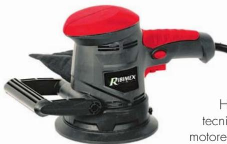
Levigatrice orbitale (PRP0125) da 220-240V~50 Hz. Caratteristiche tecniche: potenza del motore 450 Watt; peso 1,5 kg; piatto di levigatura Ø 125 mm con sistema di fissaggio scratch del foglio abrasivo; impugnatura Soft Grip per un miglior comfort d'utilizzo; fornita di foglio abrasivo (grana 100); sistema di aspirazione integrato con sacco di raccolta della polvere; giri al minuto: 7000-14000.
